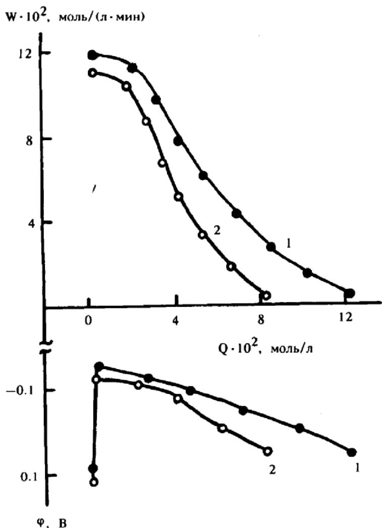
Рис. 2. Конверсионные и потенциометрические кривые окислительного аминирования  $P_4$  в растворе  $Cu(PrCO_2)_2$ – $Et_2NH$ – $PhMe$ – $Py$ – $O_2$  при двух последовательных добавках  $P_4$  (1, 2), 319 К, и концентрациях, моль/л:  $Cu(PrCO_2)_2$  –  $4.2 \cdot 10^{-1}$ ,  $Et_2NH$  – 2.9,  $P_4$  –  $2.6 \cdot 10^{-2}$ ,  $PhMe$  – 1.9,  $Py$  – 6.2,  $O_2$  –  $1.5 \cdot 10^{-3}$ .
